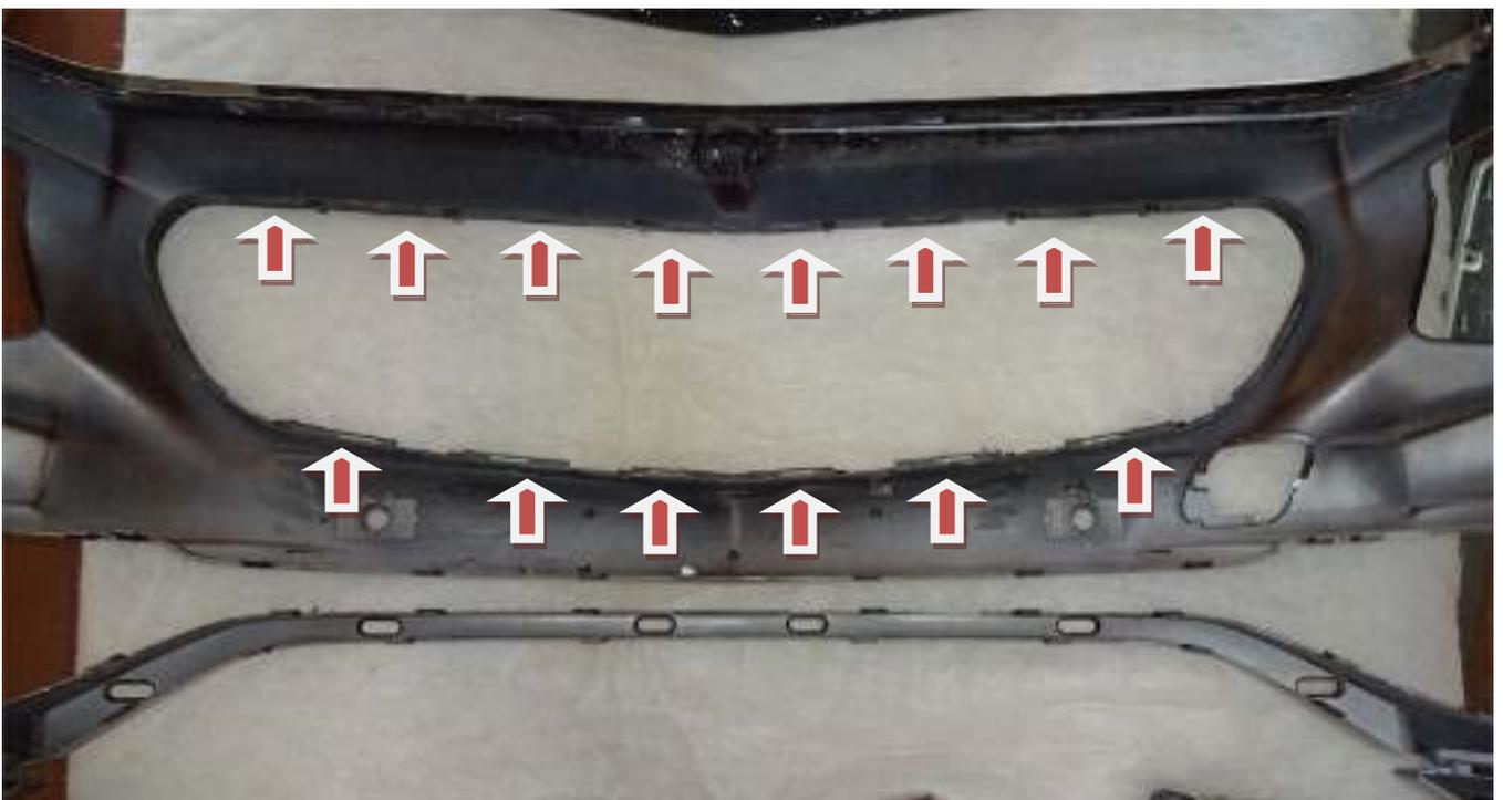
4. Innenträger herausnehmen, Stoßstange mit Grill auf den Kopfstellen. Klammer vom Grill demontieren. Grill Ausbuchtung mit Grill reichlich mit entspanntem Wasser besprühen. Dazu einem halben Liter Wasser mit ca. 5 Tropfen Seifenlauge (Spülmittel) einfüllen gut schütteln. Jetzt die Klebebänder sowie Aufnahme der Stoßstange reichlich einsprühen. Die Seifenlauge sollte eine leicht schmierige Konsistenz haben.
