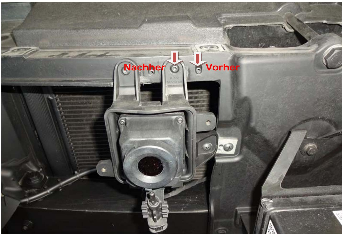
11. Aus optischen Gründen wird empfohlen der Querträger (ALU) vorne durch eine schwarz Lackierung, im sichtbaren Bereich, zu versehen. Bei Alufarbenen Kühler Lammellen empfehlen wir ebenfalls die schwarz Lackierung.
