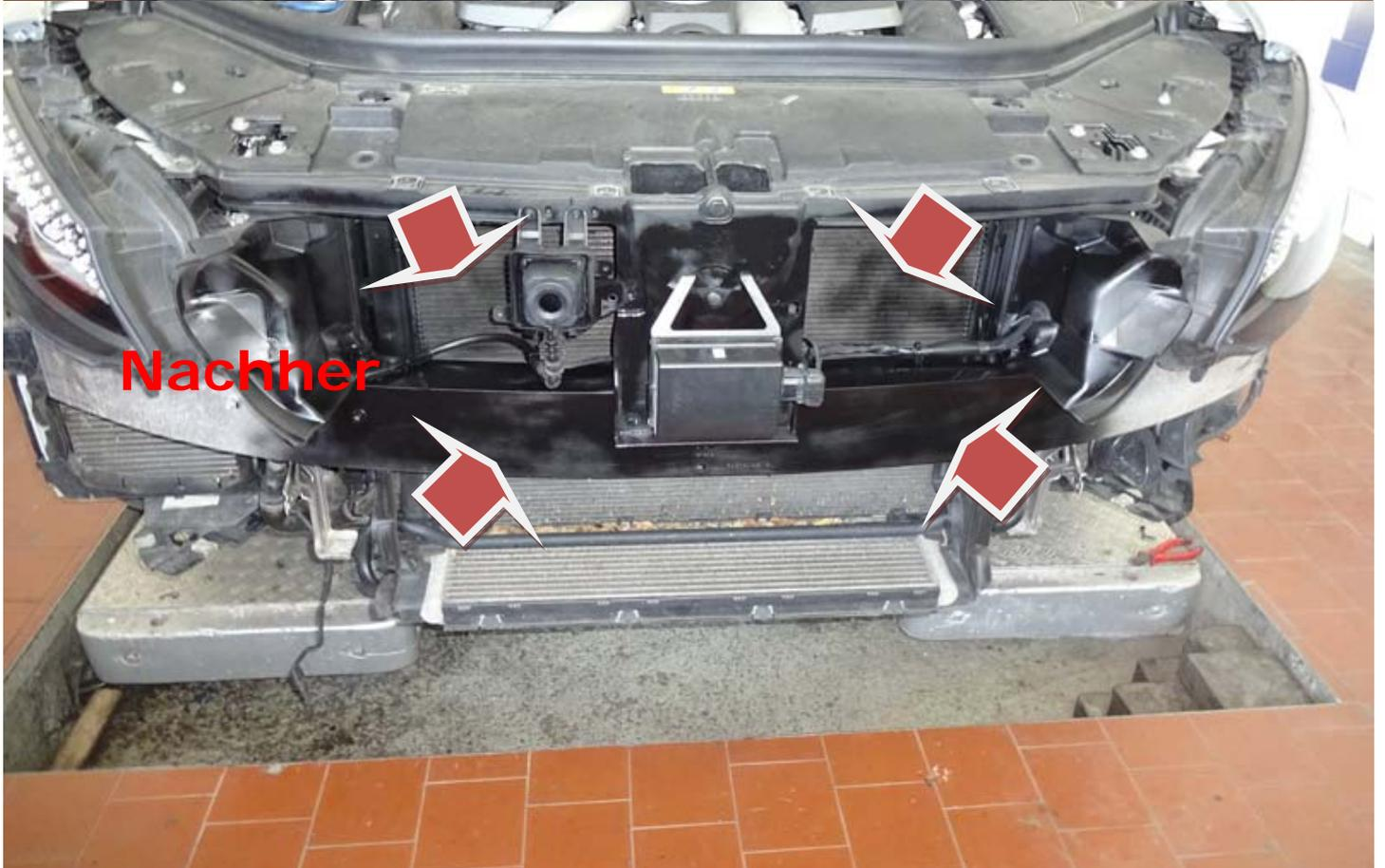
12. Bei Lieferungen ohne Bestellung des AMG Logo links im Grill wird die Aufnahme verschlossen. Bei Nachträglicher Anbringung von dem AMG Logo wird empfohlen dieses durch Verklebung mit PU auf der Aufnahme zu verbauen. Je nach Grill Ausführung ist das AMG Logo einzupassen.
