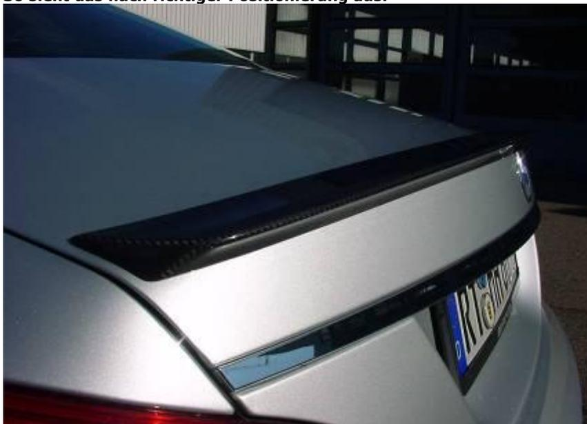
2. Reinigen Sie den Bereich des Kofferdeckel vor und nach der Kofferdeckelkante mindestens 20cm. Legen Sie den Heckspoiler auf den Kofferdeckel auf. Wir empfehlen eine Schutzverklebung.
