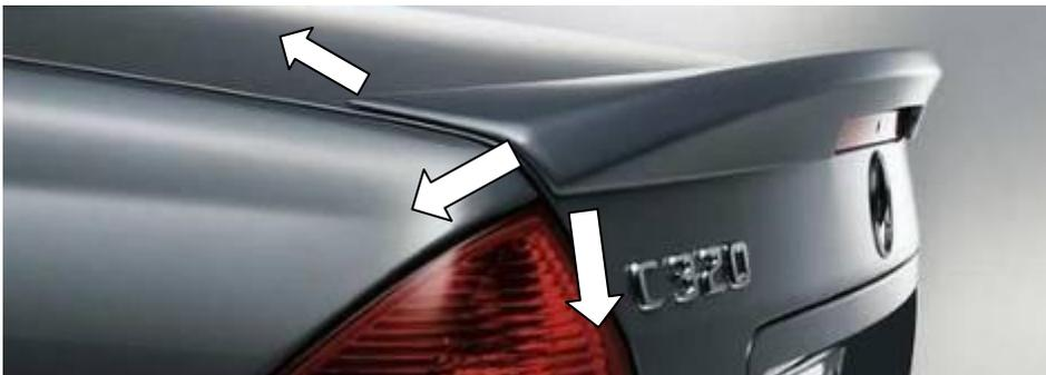
11. Bei Modellen mit einer Höchstgeschwindigkeit von über 200 km/h empfehlen wir zusätzlich zu der Klebebänder Befestigung mehrere Punkte PU-Kraftkleber anzuwenden.
