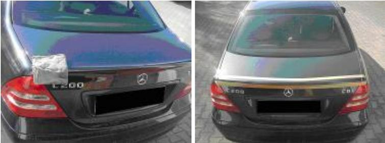
3. **Bitte um Beachtung.** Heckspoiler haben eine 3D Form und der Kofferdeckel hat eine 3D Form. Nur wenn der Heckspoiler montagekonform auf dem Kofferdeckel aufliegt ist eine zufriedenstellende Passform zu erzielen. Geringfügiges Versetzen des Heckspoiler auf dem Kofferdeckel führen zu einem guten bzw. schlechter Passform.
