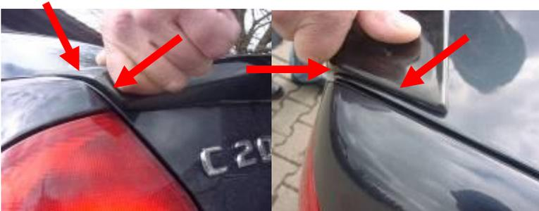
Stark geformte bzw. gewölbte Bauteile werden so hergestellt, dass einen Anlage in der Mitte auch ohne Druck gewährleistet ist. Diese gewölbte Vorspannung führt dazu, dass die Bauteile außen leicht abstehen und leicht bis mittelkräftig angepresst und in Position gehalten werden müssen. Durch dieses aufwendige Produktionsverfahren ist es möglich das Bauteil nur durch Fixierung außen, auch mittig mit dem ausreichenden Anpressdruck versehen ist. Mitteln Sie den Heckspoiler nach links und rechts aus.
